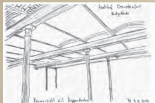
unten: Auf verzierten, gusseisernen Säulen und Stahlträgern ruht die Kappendecke der Stallungen. Sie ist bogenförmig verklinkt. (Skizze Manfred Blanke)
